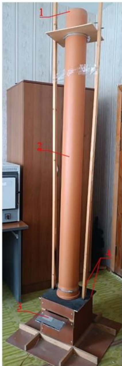
Рис. 4. – Экспериментальная установка и исследуемый материал: а – установка для определения скорости осаждения частиц полиэтилена: 1 – сбросное отверстие с заслонкой; 2– труба для сброса материала; 3 - прозрачное стекло с подсветкой; 4 – каркас установки; б – фиксирование падения частиц камерой, подключённой к компьютеру; в – фото исследуемых частиц СВМПЭ
