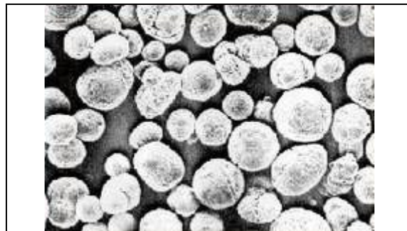
Рис. 1 - Электронная фотография порошка СВМПЭ
